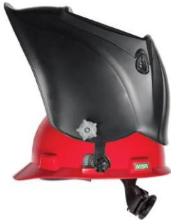
Máscara de Solda com Escurecimento Automático utilizada para trabalhos com soldagem acoplada ao capacete V-Gard: A Máscara de Solda é confeccionada em material plástico (Nylon) preto. Possui visor com escurecimento automático com regulagem de escurecimento (Shade 8 à 13), controle de atraso (Delay) e sensibilidade. A máscara é fixada em um suporte basculante (Poliacetal), preso através de parafuso plástico (Nylon) e fixado na haste para encaixe nas fendas laterais do casco do capacete.
